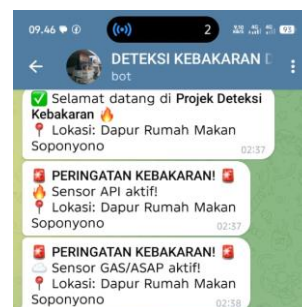
Gambar 5. Tampilan notifikasi Telegram saat sistem mendeteksi bahaya kebakaran
