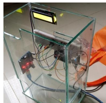
Gambar 3. Prototipe sistem deteksi kebakaran yang telah direalisasikan
