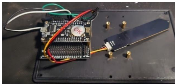
Gambar 9. Rangkaian Komponen NodeMCU dan Sensor Soil Moisture
