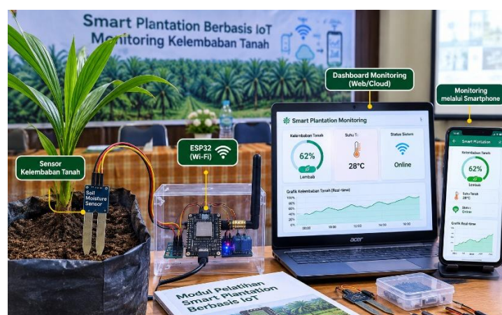
Gambar 3. Implementasi ESP32 dan Sensor Kelembaban Tanah Sebagai Sistem Monitoring
