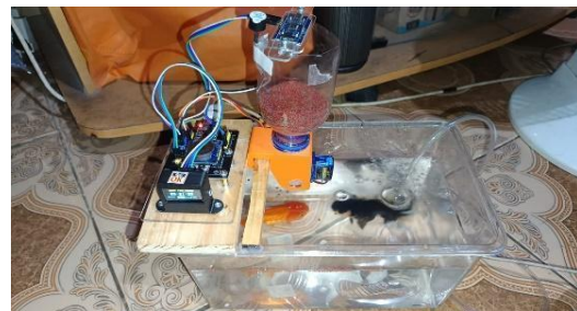
Gambar 5 Implementasi Sistem berbasis IoT
